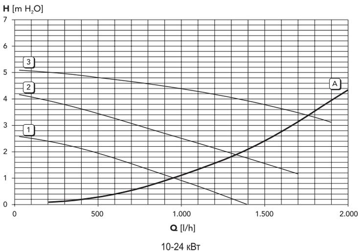
Рис. 15. Потери напора/давления циркуляционного насоса
