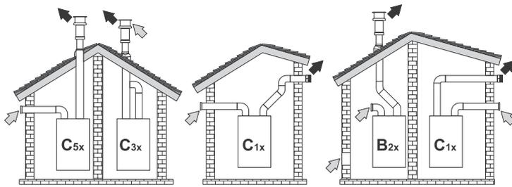
Рис. 10. Примеры присоединения с помощью раздельных труб
