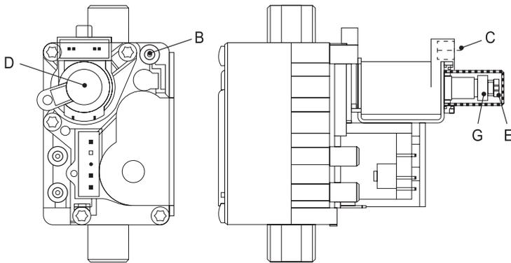
**Рис. 12. Газовый клапан**
