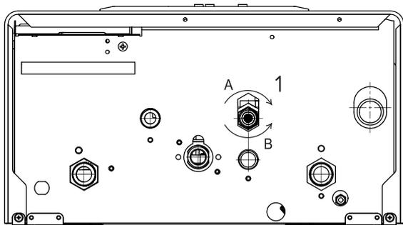
Рис. 2. Клапан наполнения
