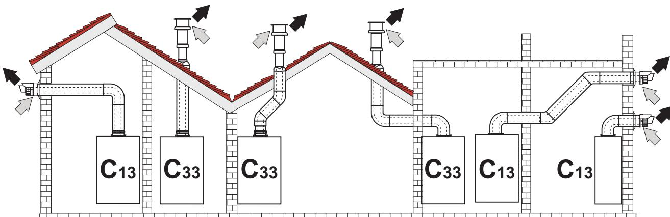
рис. 31- Примеры подсоединения с помощью коаксиальных труб
