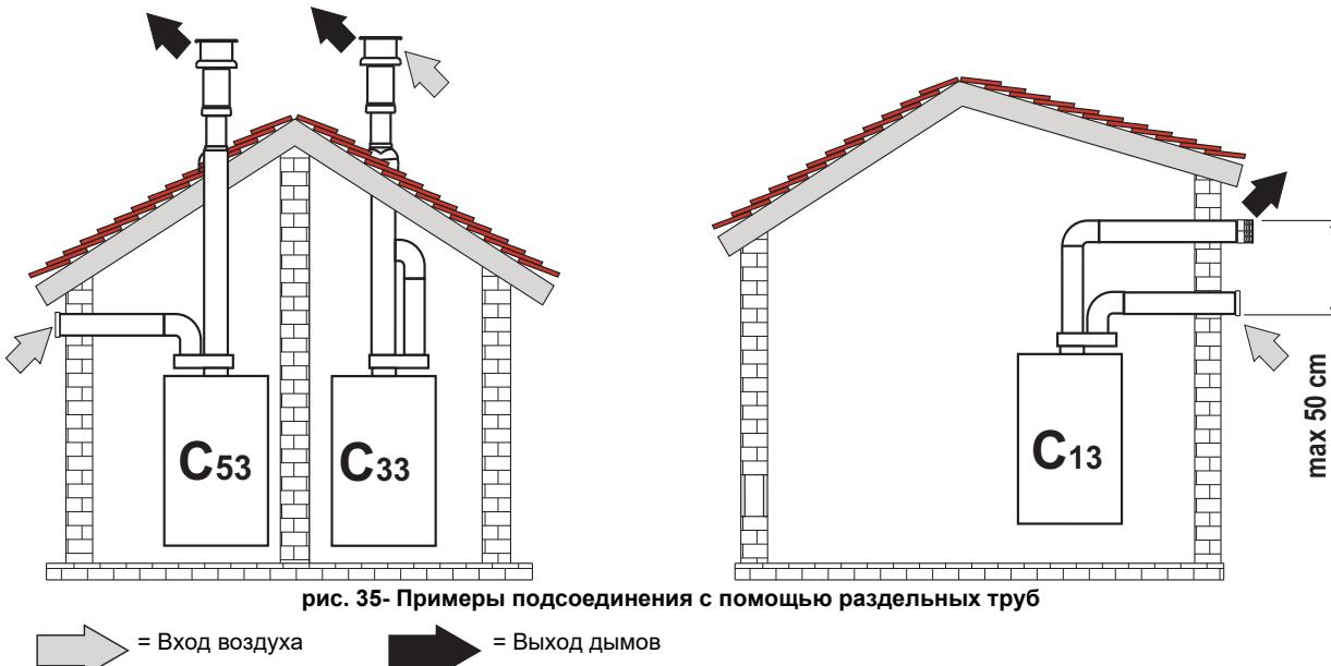
рис. 35- Примеры подсоединения с помощью раздельных труб
