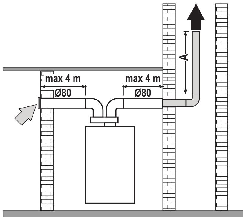
рис. 39- Схема с использованием только гибкой трубы
