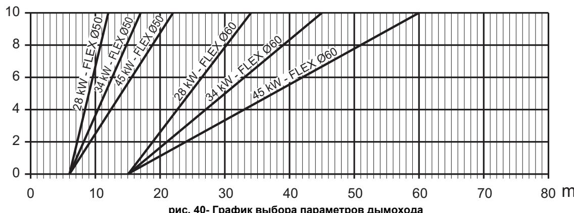
рис. 40- График выбора параметров дымохода
