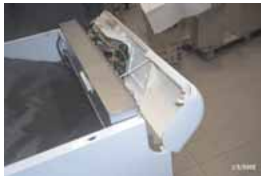
Рис. 6 - Поверните панель управления вперед.
