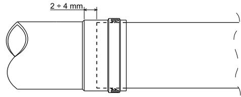
рис. 6 - Тепловое расширение
