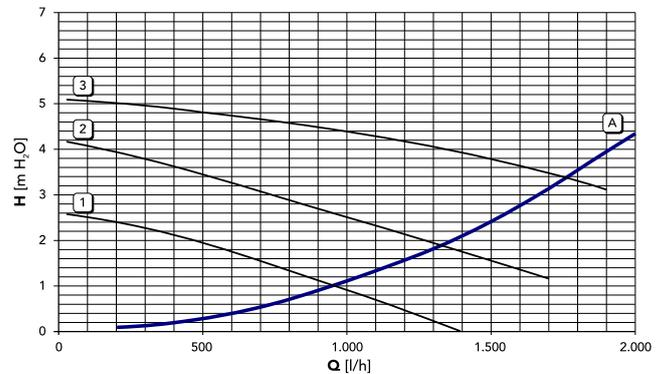
A = Потери напора в котле - 1, 2 и 3 = Скорость циркуляционного насоса
