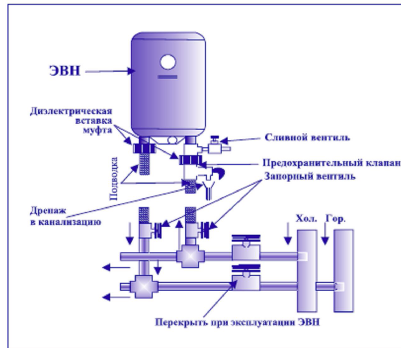
Рис. 2. Схема подключения ЭВН к водопроводу
