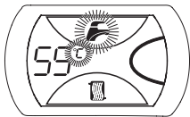
Рис. 5 Индикация настройки температуры ГВС
